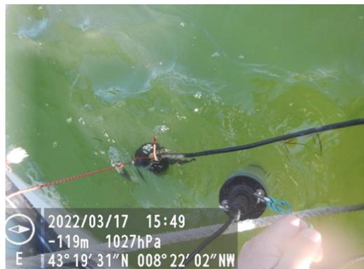
Comprobación de las anomalías mediante medidas en paralelo con sonda multi-paramétrica recién calibrada.
